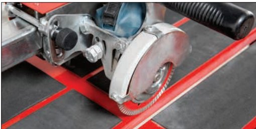
İstenilen derinlikte dik kesimler ve pah kesimler yapılır.
