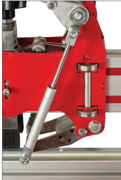
Sabit baskı kuvvetini sağlayan gazlı amortisör sistemi
