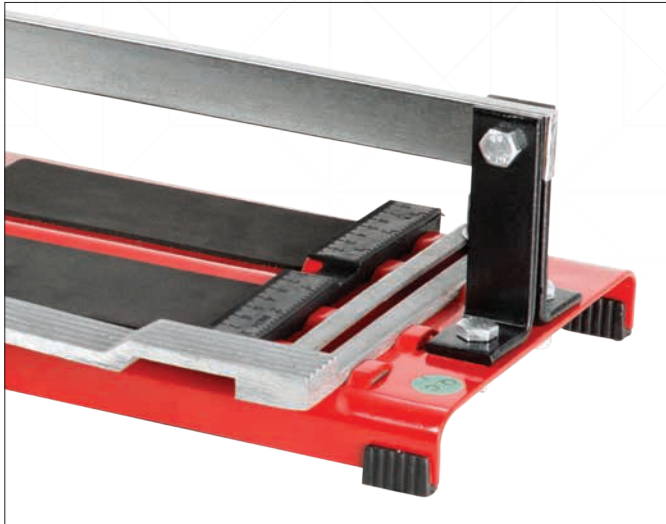
Dereceli dayama ve gönyesi bulunmaktadır.
