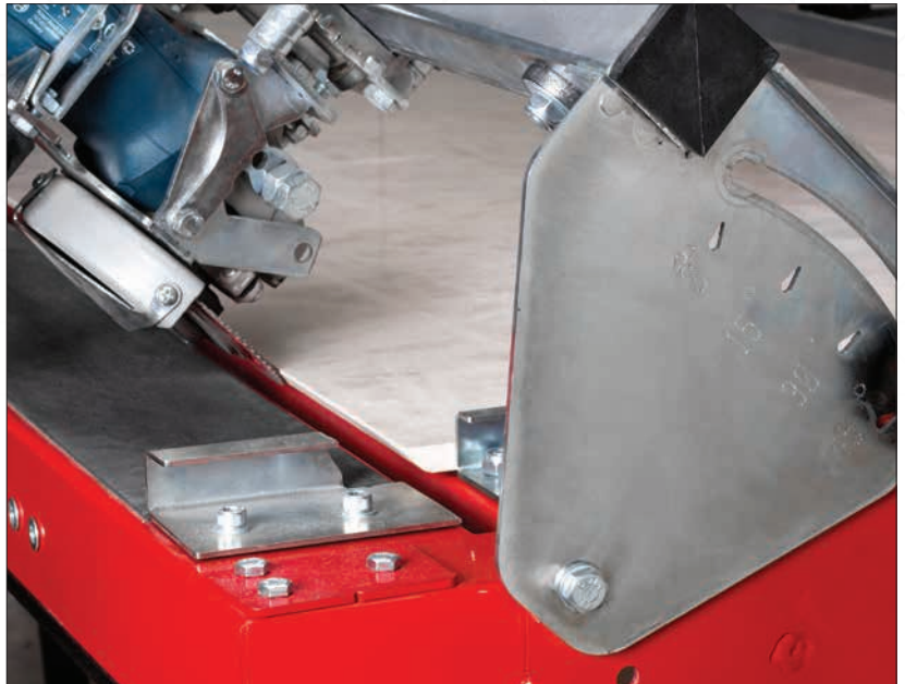
Titan'ın takozları 45°'ye getirilerek çapaksız ve pürüzsüz pah kesimler yapılabilir.
